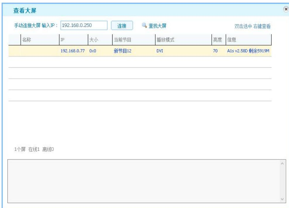
③无线网：播放盒正常启动后会启动 MC100APXXXX 的开放热点，使用电脑在盒子附近连接该热点。打开软件，点击查看大屏或者管理——监控在线 LED 屏，在上方输入框内输入 IP: 192.168.43.1 点击连接，在下面的显示区域会显示此无线热点的播放盒。
